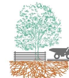
Protection du sol par une piste de chantier
