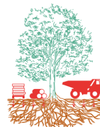
Compactage du sol
